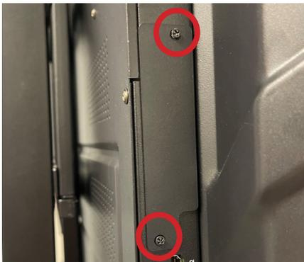
2. Insérez le Module Wi-Fi dans le port correspondant jusqu'à ce qu'il soit bien en place et utilisez les 2 vis pour le sécuriser.
